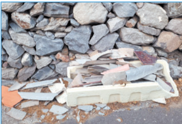
Asbest ist gefährlicher Sondermüll (Foto/AyVallehermoso)
